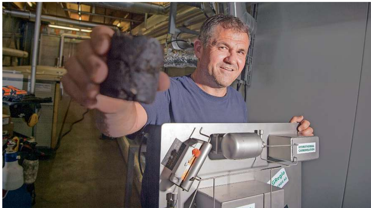
Andreas Mehli in seiner HTC-Anlage: Aus Biomasse wie Klärschlamm entsteht Biokohle. Antibiotika oder Hormone werden beim Verfahren zersetzt, der wertvolle Phosphor bleibt erhalten und kann aus der Kohle separiert werden.
